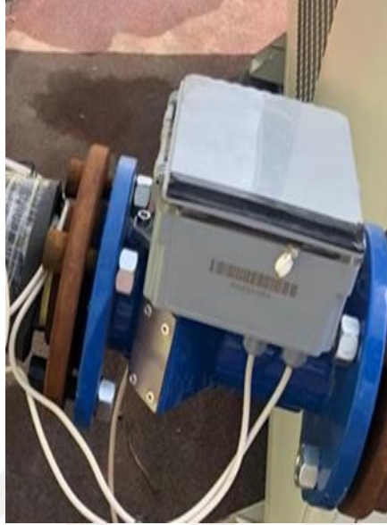
Şekil 4.27. Atlas UKM-50 ultrasonik akış ölçer ve kalorimetre
