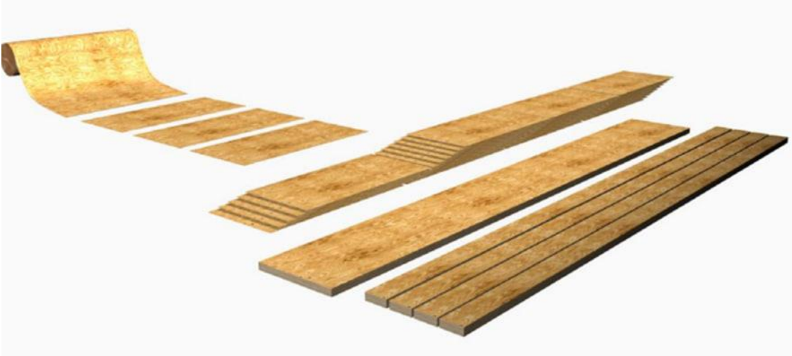
Şekil 3.3: Endüstriyel Ahşap Üretiminin Aşamaları (LVL Handbook Europe, 2020).
