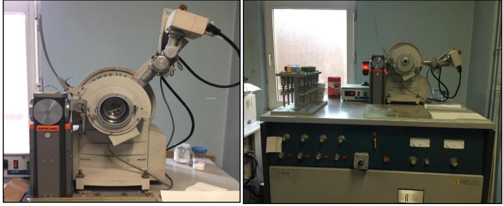
Şekil 3.13: XRD cihazı (solda) dış görünümü, (sağda) gonyometre, x-ışını tüpü, dedektör ve numune tutucu.
