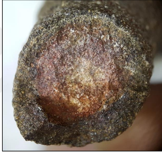
Şekil 3.3: Çalışılan fulgurit örneğinin uzun eksenine dik kesitinden iç yapısının görünümü.
