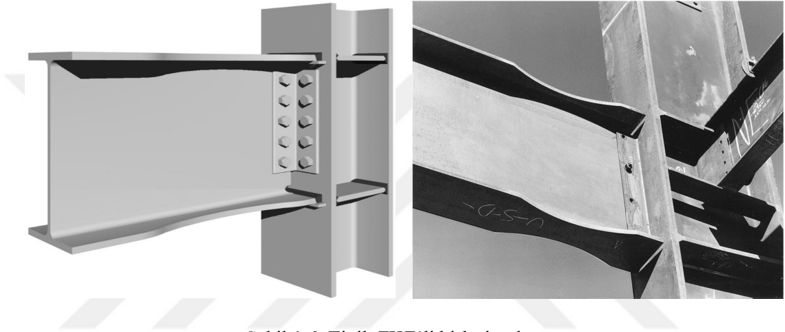
Şekil 1.6: Tipik ZKE’li birleşim detayı
