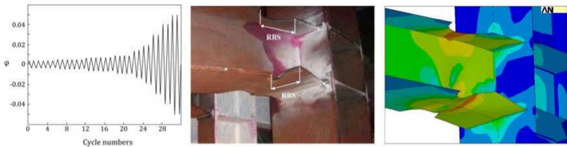
Şekil 4.7 : SAC yükleme protokolü , Pachoumis ve diğ. tarafından yapılan deney fotoğrafı, ve sağ resimde Tsavdaridis ve diğ. yaptığı analitik çalışmanın görüntüsü
