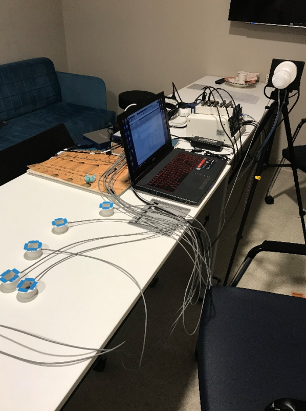
Şekil 2.2. Ölçüm sistemi. Hans Rudolph pneumatograf akış sensörü ve Adafruit Electret Mikrofonları içeren havzalar görülmektedir.
