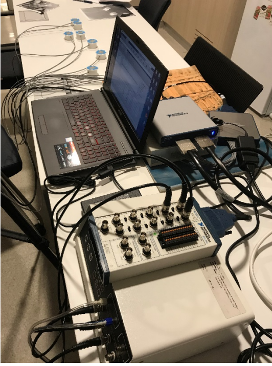
Şekil 2.1. Ölçüm sistemi. Hans Rudolph pneumatograf, National Instrument USB-6363 veri toplama ünitesi ve MSI marka GV62 8RC model taşınabilir bilgisayar görülmektedir.
