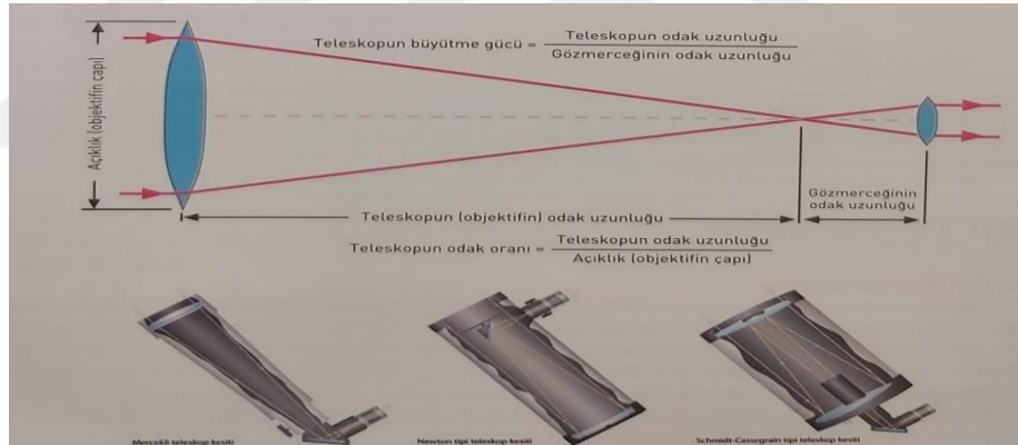
Şekil 5: Teleskop büyütme gücü ve Teleskop odak oranı bağıntıları. Mercekli teleskop kesiti, Newton tipi teleskop kesiti, Schmidt Cassegrain tipi teleskop kesiti (Akoğlu, 2009).
