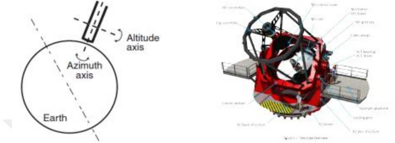
Şekil 29: Sol: Alt azimut kavramı. Sağ: DAG (Baudeta, Jolissainta, Keskin, Yeşilyaprak, & Yerli, 2016)
