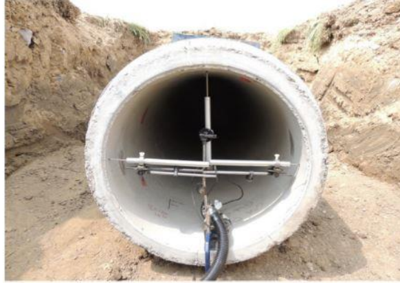
Şekil 4.32: Boru kurulumunda kullanılan gerilme ölçerler (Nehdi vd., 2015)
