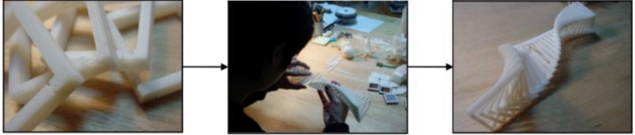
Şekil 5. Hızlı prototipleme ile üretilen parçaların birleştirilmesi (Tang, 2006)
