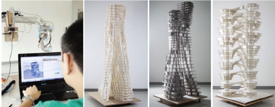
Şekil 9. Robotlarla Üretilen Yüksek Katlı Bina Alternatifleri (Budig ve diğ, 2014)
