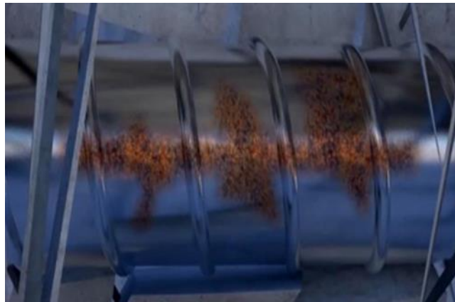
Şekil 2.7. Yapıdaki çeliğin nem sonucu paslanması (URL-1)
