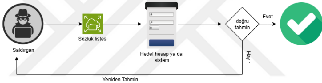
Şekil 2.6. Sözlük saldırısının şeması
