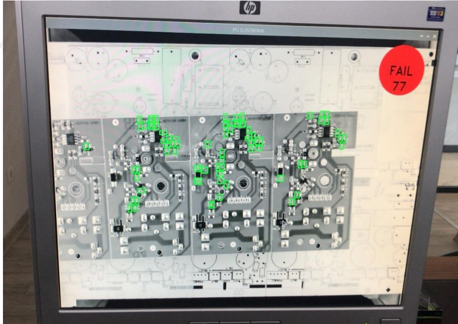
Şekil 6.9: Yüksek hatalı kart için test aşaması tahmin sonucu. 77 adet lehimsiz bacak doğru olarak kestirilmiş.
