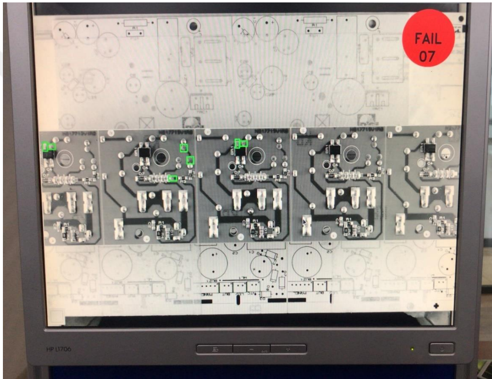
Şekil 6.10: Fazla lehimsiz sınıfı tespiti örneği
