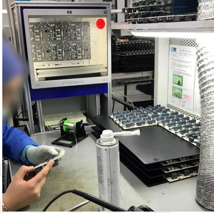
Şekil 6.5: Cihazın üretim hattında karışık kartlar ile testi
