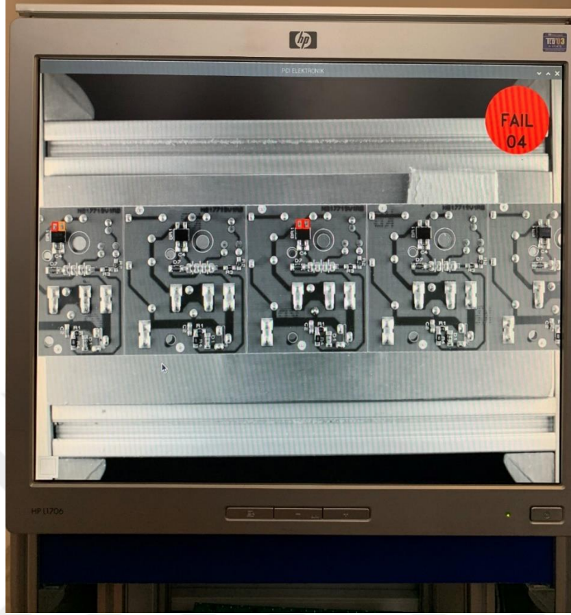
Şekil 6.7: Test aşaması tahmin sonucu: Karta herhangi bir rotasyon uygulanmamış ve lehimsiz bölgeler doğru tespit edilmiş.
