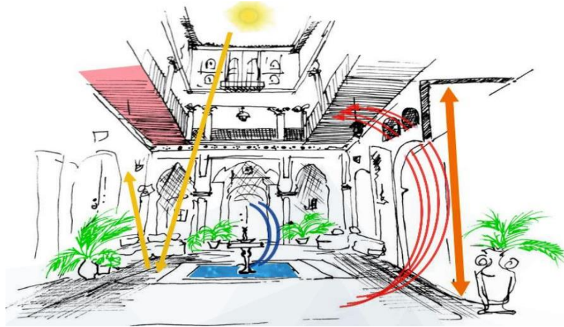
Şekil 4. 13. Avlulu evi doğal havalandırma ve güneş kontrolü (Caldas, 2011)
