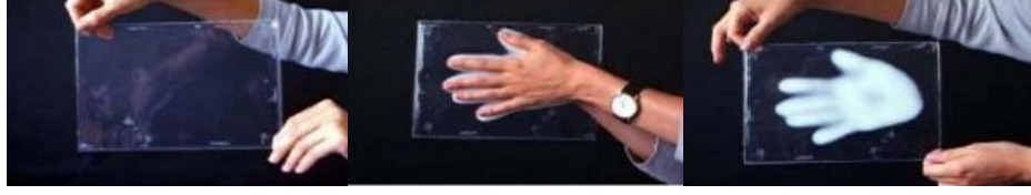
Şekil 7. Termotropik malzeme kullanılan camın opaklık durumu (Pahlavan, 2011)
