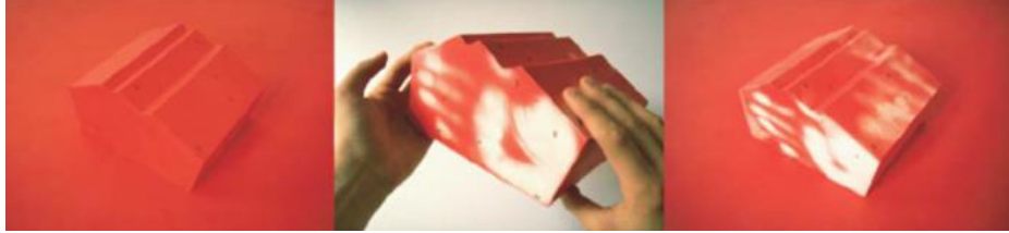
Şekil 6. Termokromik malzemelerin dokunma hafızası (Addington ve Schodek, 2005)
