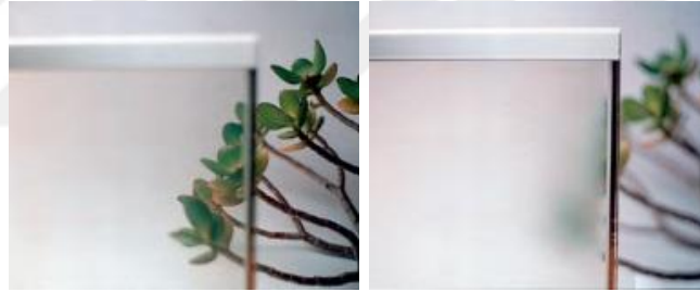
Şekil 8. Elektrooptik camın şeffaf ve opak durumunun gösterimi (Ritter, 2007)
