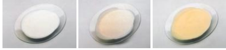
Şekil 4. Fotokromik pigmentlerin ışık etkisi ile renk değiştirme aşamaları (Ritter, 2007)
