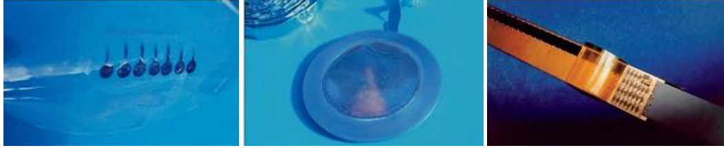
Şekil 15. Piezoelektrik malzemedan üretilen sensörler (Ritter, 2007)
