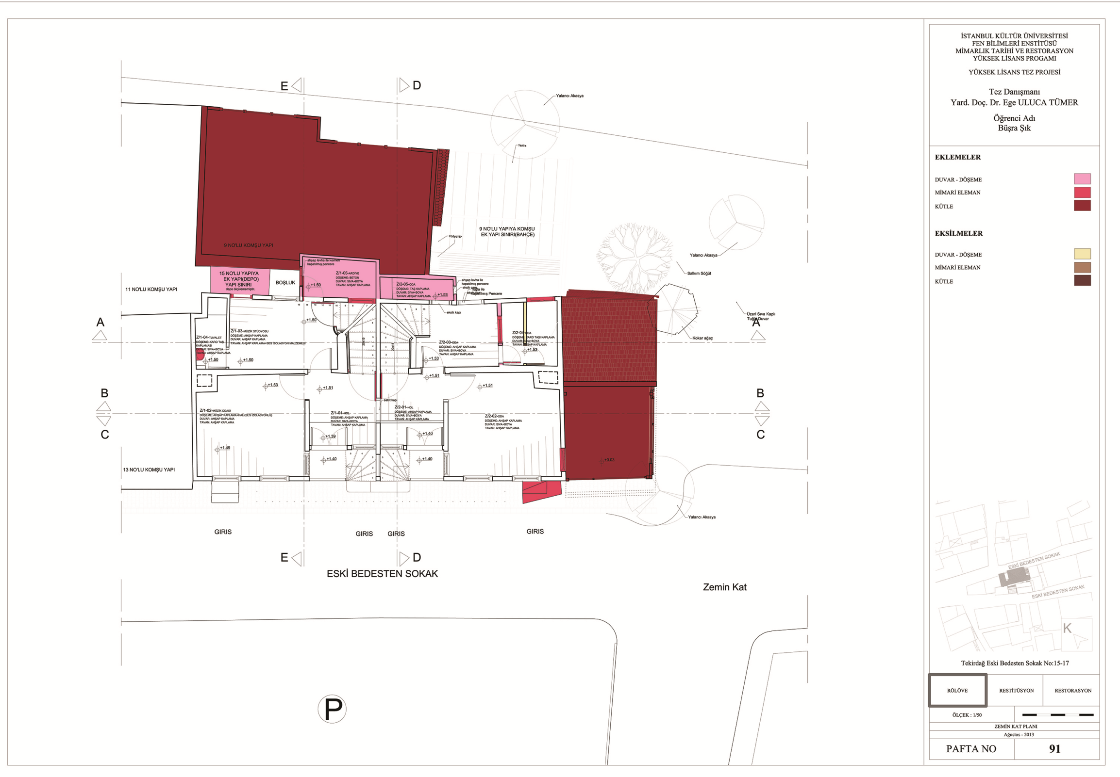
Şekil 4-210 Zemin Kat Planı – Eklemeler-Eksilmeler (2013)
