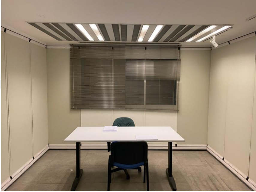
Şekil 4.7. Senaryo 01: 500lx sabit aydınlık düzeyi, 3000K renk sıcaklığı
