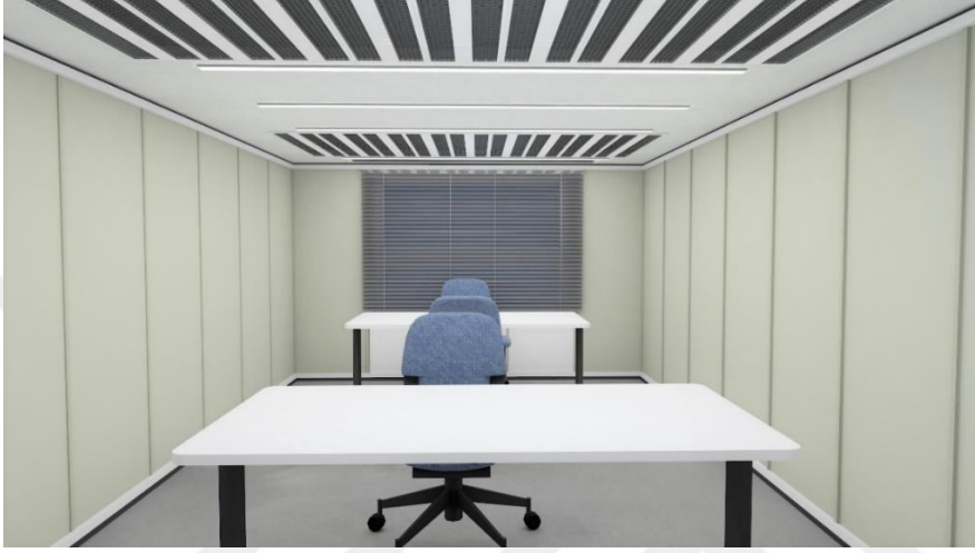
Şekil 4.11. Senaryo 05: 6500K DiaLux Evo 9.0 Lineer LED simülasyon
