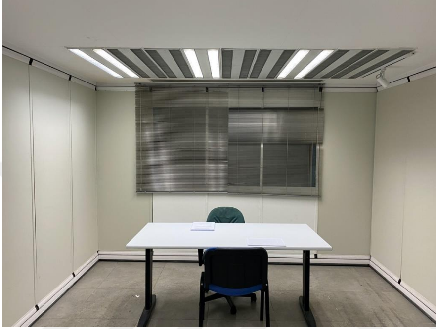
Şekil 4.9. Senaryo 03: 500lx sabit aydınlık düzeyi, 6500K renk sıcaklığı
