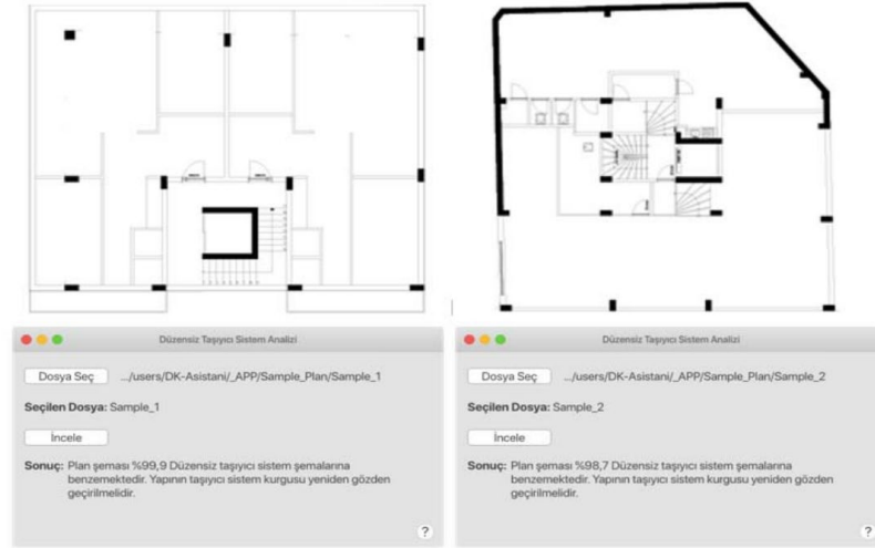
Şekil 2.19 DK Asistanı Aracının, Düzensiz Taşıyıcı Sistemli Planlar için Verdiği Yanıt (Bingöl vd., 2020)
