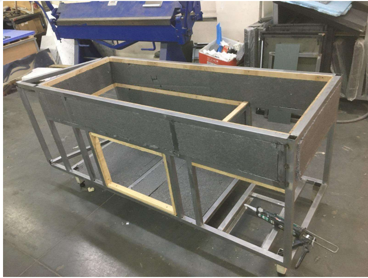
Görsel- 17: Modüler sistem uygulaması öncesi Soğutmalı Bölüm karkas imalatı
