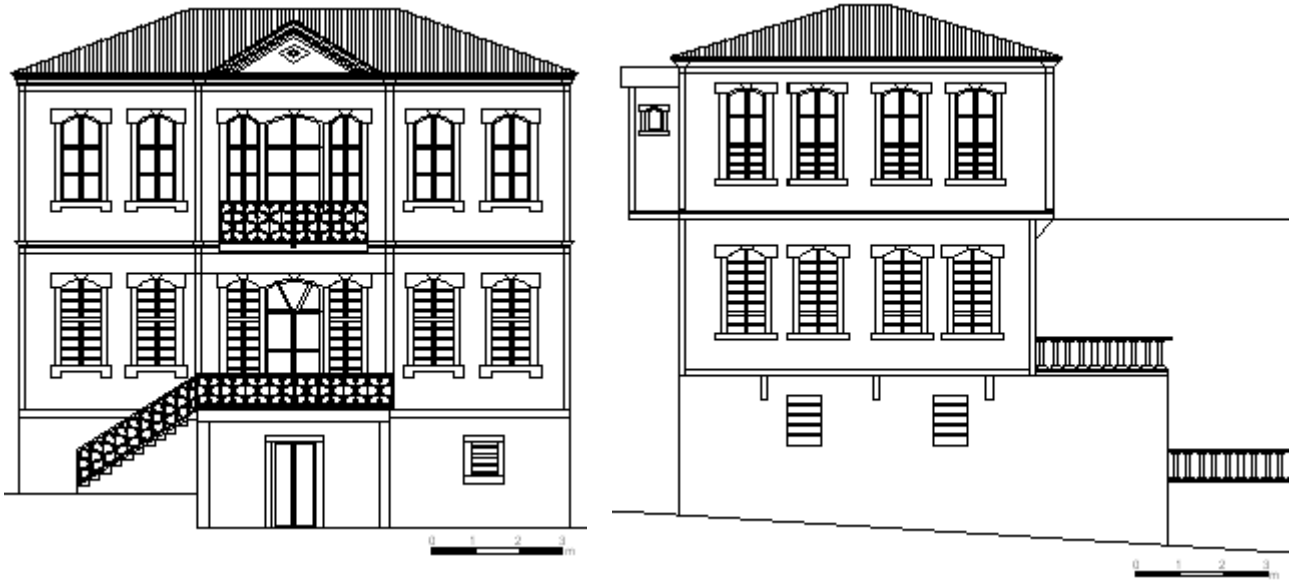
Şekil 18. Giriş önu mekânının demir ve taş malzemeli korkulukları.
