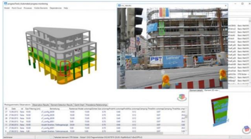
Şekil 3.38. Kaba Haldeki Bir İnşaatın İlerleme Durumunun Tesbiti (Wang, Cheng ve Sohn, 2015)
