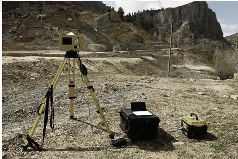
Şekil 3. 32. Yersel Lazer Tarama Cihazı Bileşenleri (Kim vd, 2016).
