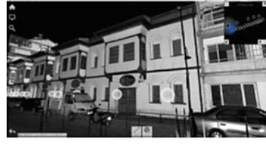
b) Lazer tarama ile oluşturulan BIM Modeli
