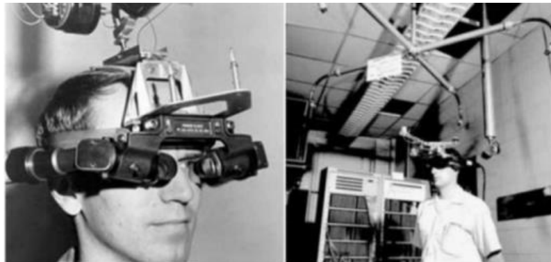
Şekil 14: TheSword of Damocles - (Domaclesin Kılıcı) – ilk giyilebilir AG örneği (Arabacıoğlu, 2019).
