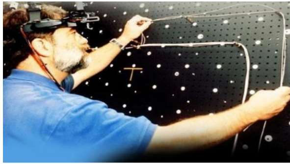
Şekil 15: Caudell ve Mizell tarafından geliştirilen AG sistemi (Ballı, 2021).
