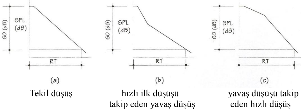
Şekil 3.5 : Basit ses düşüş grafikleri (a) Tekil düşüş (b) Hızlı ilk düşüşü takip eden yavaş düşüş (c) Yavaş ilk düşüşü takip eden hızlı düşüş [10].
