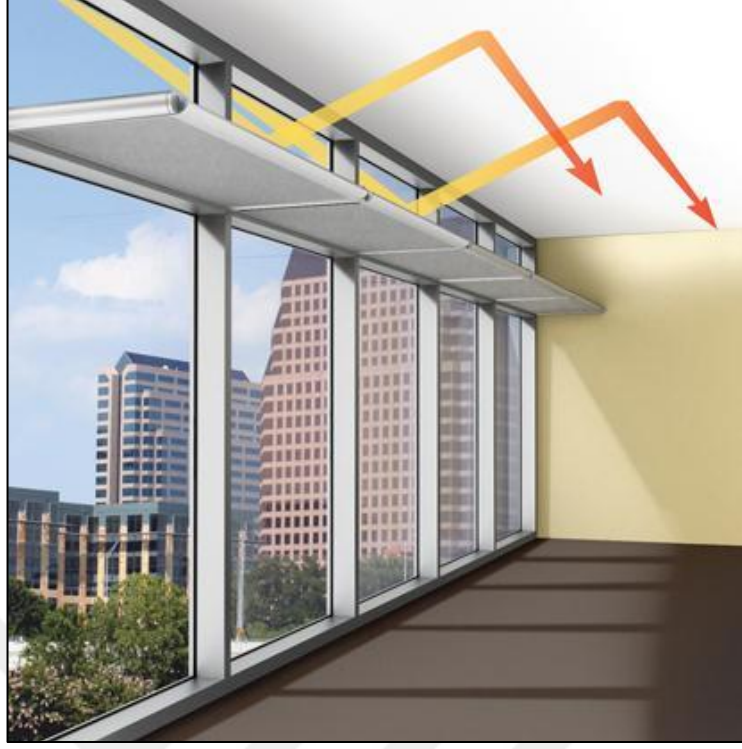
Şekil 4.4. Işık rafları sistemin uygulaması (designbuildings, 2020)
