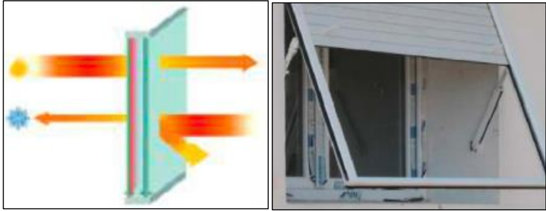
Şekil 4.7. Al Ouard projesinde kullanılan çift cam ve güneş kırıcılar ( https://alomrane.gov.ma , 2018)
