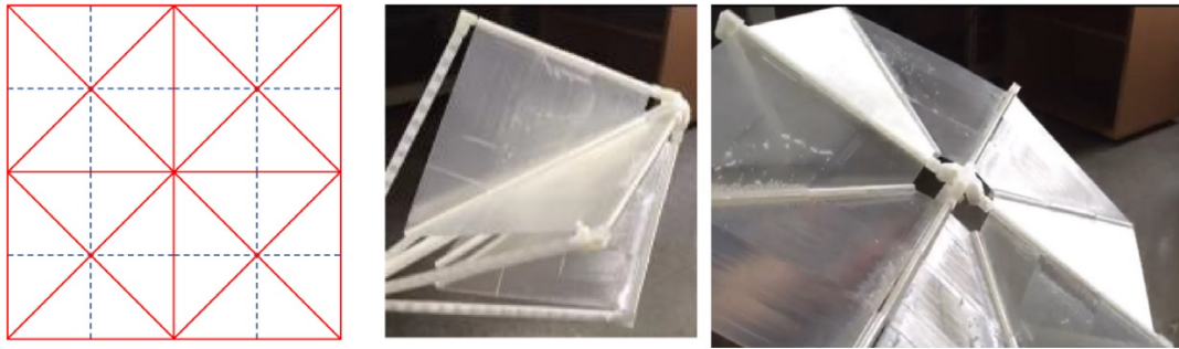
Şekil 2.19: Yi vd. (2020) tarafından 3D yazıcı ile üretilmiş gölgelendirme elemanı ve tasarımında tercih edilen origami deseni.
