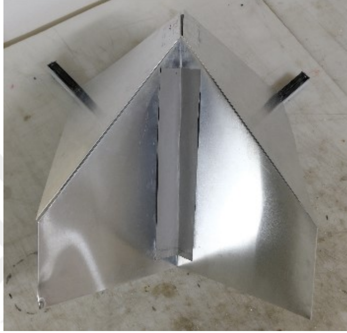
Şekil 4.10: Birleştirilmiş olan cephe elemanı prototipi.
