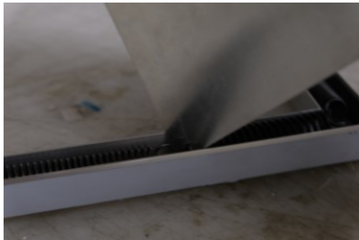
Şekil 4.9: Sistemin hareketini sağlayan yay çifti.
