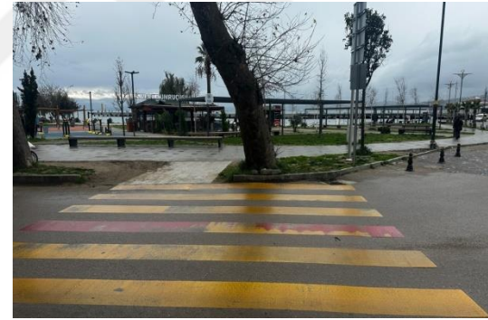
Şekil 5.6: Proje kapsamında engelli ulaşımında ve yaya geçitlerinde yapılan tasarım hataları (Yazarın özel arşivi).
