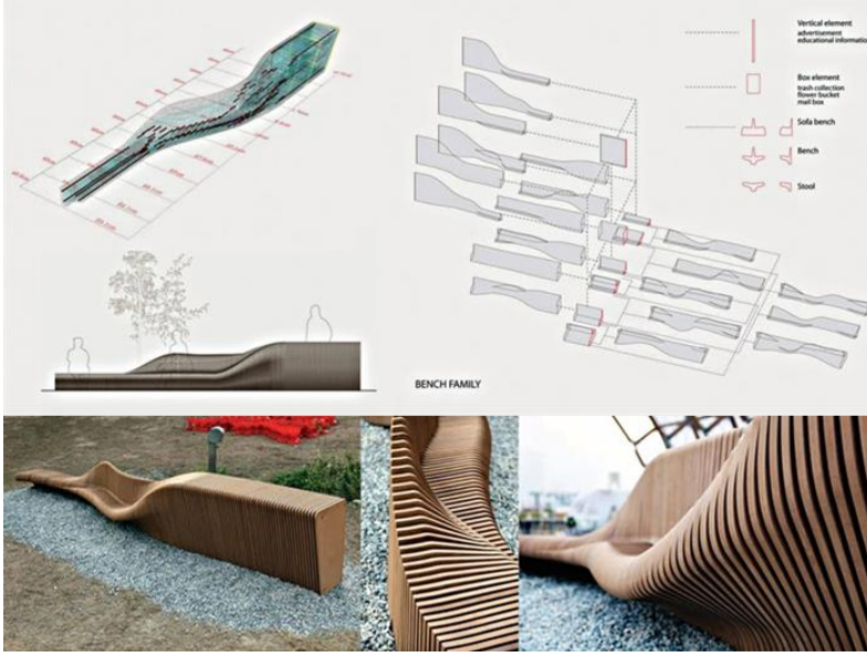
Görsel 36: Yapı mimarlık tasarım kültür sanat dergisi – Parametrelerin tasarım aşaması ve montaj sonrası görünümü
