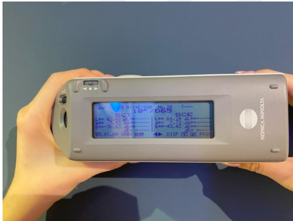
Şekil 4.20 : Spektrofotometre cihaz ile mağazada yapılan ölçümler
