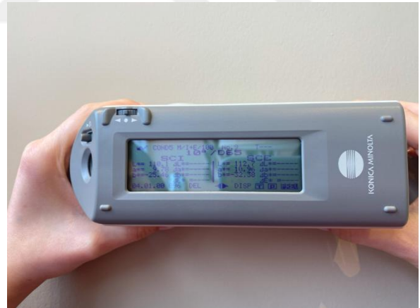
Şekil 4.20 : Spektrofotometre cihaz ile mağazada yapılan ölçümler
