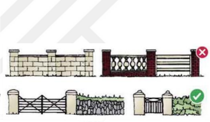
Şekil 6.5. Sınır Öğelerinin Tasarımında Yerel Taş Malzemenin ve Bitki Elemanlarının Kullanılması Gerektiğini Gösteren Şema (Conneally ve ark, 2005).
