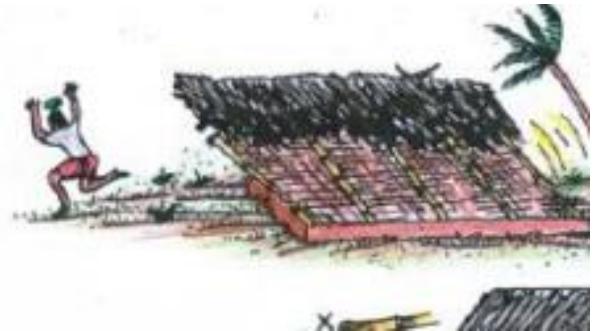
Şekil 6.3. Yapının İskelet Sisteminde Çaprazların Kullanılması Gerektiğini Gösteren Şema (Ahmed, 2005).
