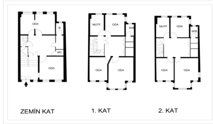
Görsel 5.47a: 4 No'lu Yapıda Görülen Mekan Sıkıntısı Nedeni İle Dışarıya Açılan İç Kapılar (G.A.)
