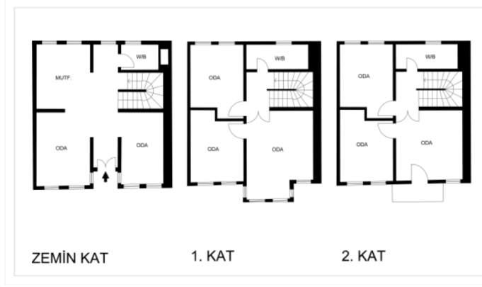
Şekil 5.26b: 25 No'lu Yapıya Ait U Merdiven Örneği (G.A.)
