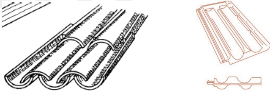
Görsel 5.8: Oluklu Alaturka Kiremit Detayı (Çavdar, 2009) ve Marsilya Kiremidi Detayı (URL 17)
