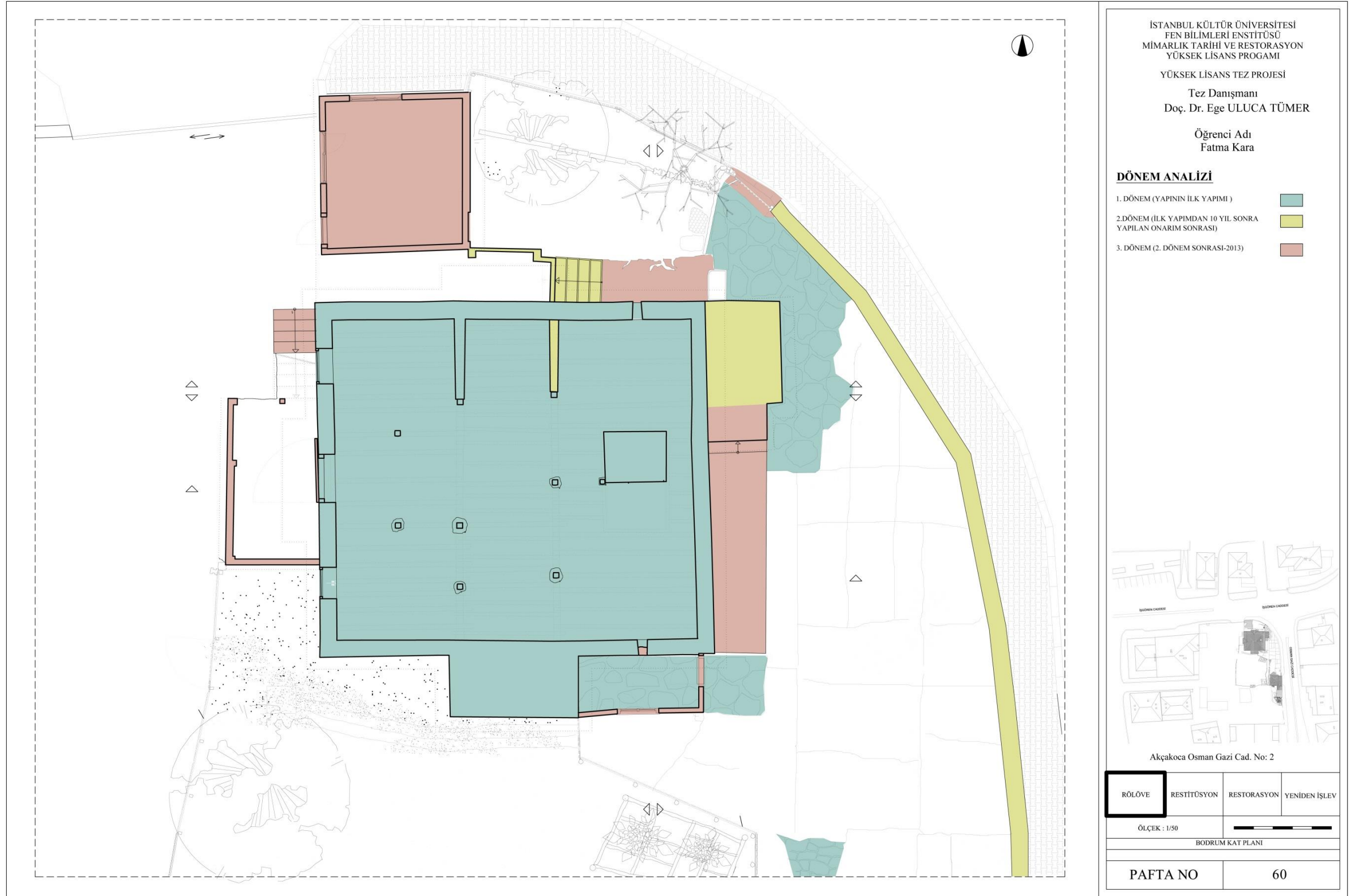
Şekil 4. 159: Dönem Analizi Bodrum Kat Planı (Kara, 2013)
