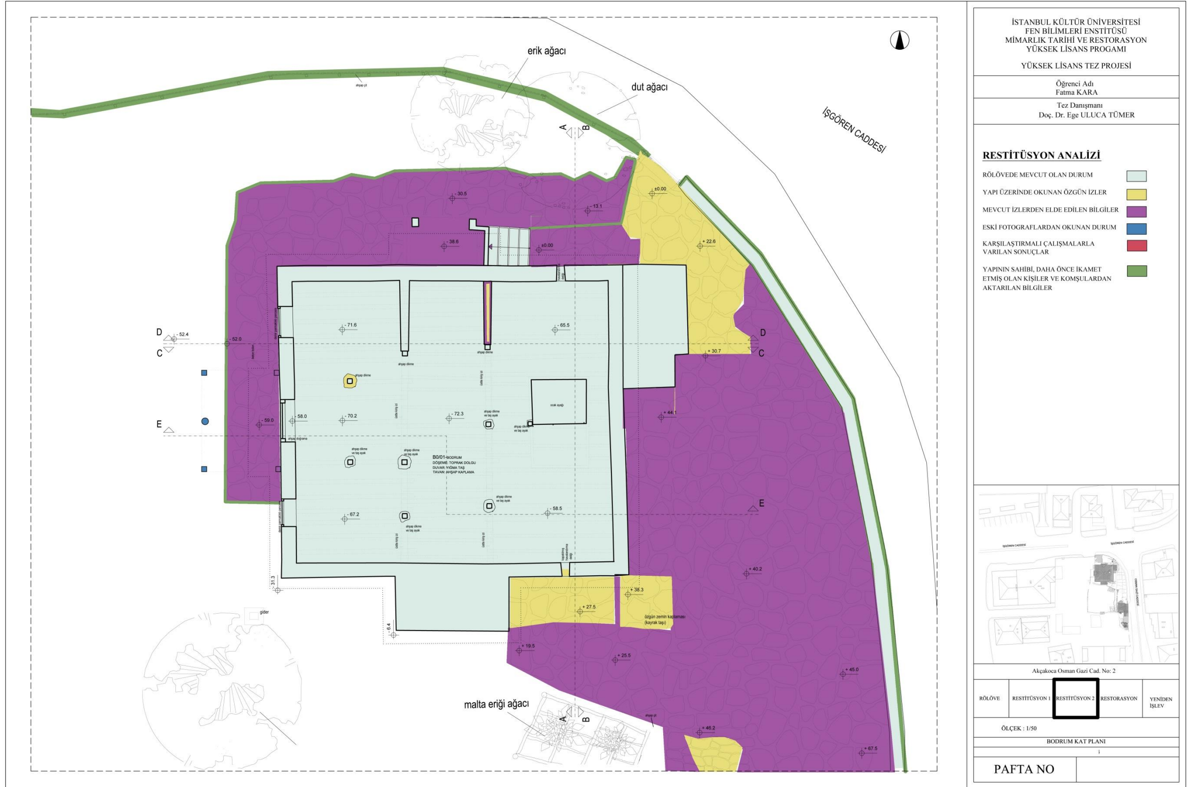
Şekil 4. 238 : Restitüsyon Analizi Bodrum Kat Planı (Kara, 2013)
